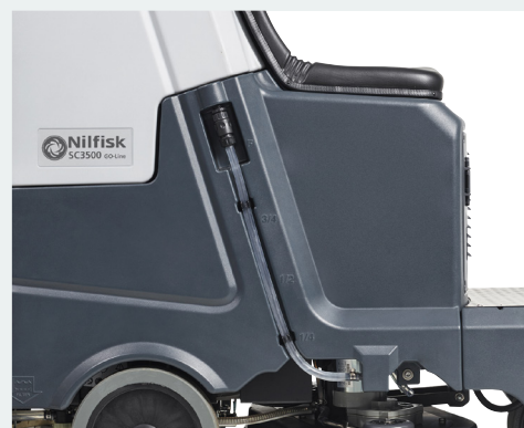
A tartályban lévő vízszint egyszerű szemrevételezéses ellenőrzése
